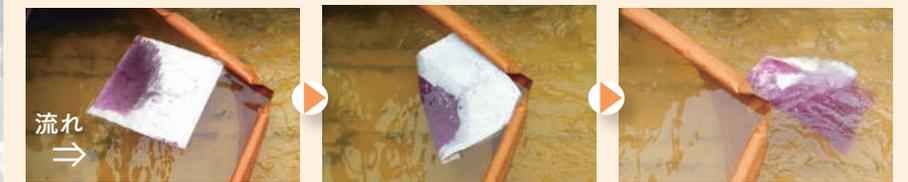
●従来型オイルマットは300ccの軽油を吸わせただけで約5分後に沈降し流下しました。
