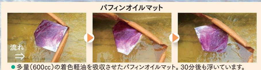
●多量(600cc)の着色軽油を吸収させたパフィンオイルマット。30分後も浮いています。
